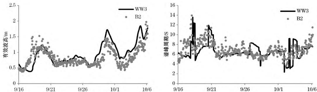
图 1 B2 测点实测值与模拟值对比图
